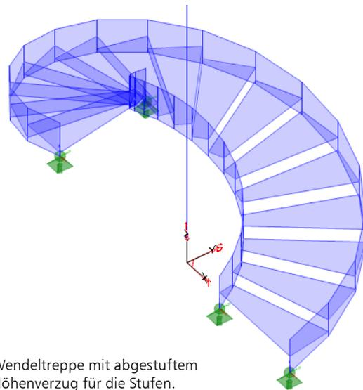
Wendeltreppe mit abgestuften Höhenverzug für die Stufen.
